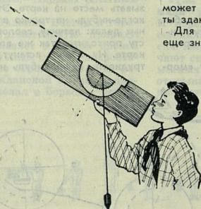
Самодельный эклиметр для определения вертикального угла, то есть высоты точки над горизонтом.
